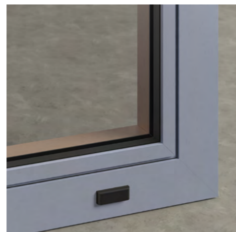
Cornici esterne mono o bicolore in alluminio con angoli saldati e telaio con aletta da 25mm (sistema brevettato)
